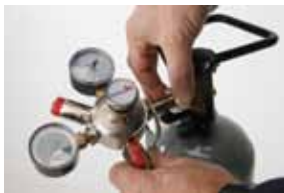
4. Druckminderer von Hand anschrauben
