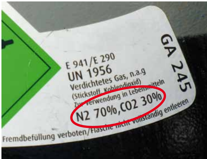
Abb. 2: Beispielhafte Beschriftung einer Druckgasflasche mit Mischgas N 2 : 70 %, CO 2 : 30 %
