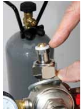
3. Dichtung am Druckminderer kontrollieren
