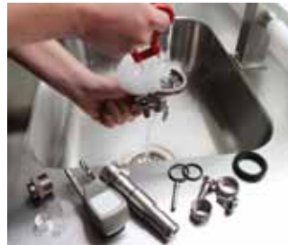
Abb. 6: Zerlegter Zapfkopf zur gründlichen Reinigung
